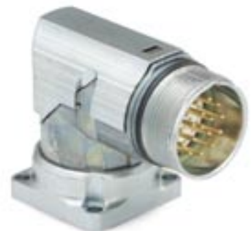
Einbaudose abgewinkelt, drehbar mit großem Flansch (28 x 28mm) Axiale Abdichtung, mit Vibrationsschutz
